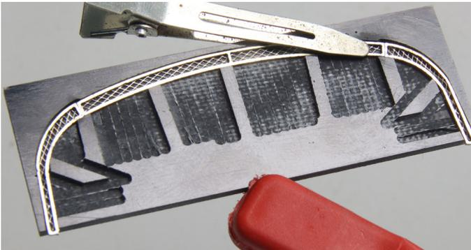
Rahmen in der Lehre zusammenlöten. Stützen (die kürzeren nach außen) nach Foto anlöten und kürzen. Umläufe mit Aceton entfetten und lackieren. Die empfindlichen Gitter nicht mit Glasradierer oder Ähnlichem traktieren.
